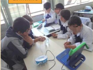
Medimos la temperatura cada 1 minuto con el sensor y la termocupla en 200 ml de agua.
