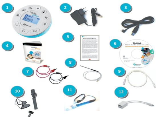
Estos sensores, permiten registrar diferentes parámetros fisicoquímicos, como pueden ser temperatura, voltaje, humedad, luz, pH, presión, sonido, distancia, GPS. Además, conectados a una XO u otro dispositivo que tenga instalado el software GlobiLab, permiten visualizar gráficas que sintetizan los datos recolectados así como también imágenes satelitales de Google Maps con el recorrido realizado.
